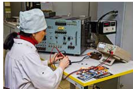
Измеряем падение напряжения. Все предохранители уложились в положенные значения.
